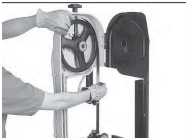
Рисунок 26. Установка ленточного полотна.
