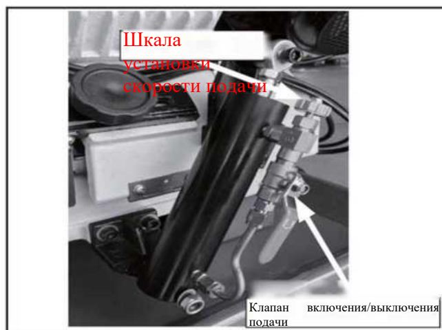
Рисунок 21. Расположение клапана включения/выключения подачи.
